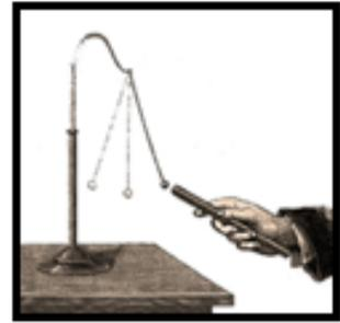
**5.- Materiales Conductores y aislantes:** En los conductores, las cargas se mueven libremente en cambio en los materiales aislantes las cargas no se desplazan libremente a través del material. Con la ayuda de la máquina Wimshurst se carga una esfera conductora, observándose su carga con el electroscopio, si luego la esfera conductora se **conecta a tierra**, ésta pierde toda su carga lo cual se observa en el electroscopio
