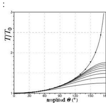
Dependencia del periodo del péndulo con la amplitud angular de las oscilaciones. Para pequeñas oscilaciones, el cociente  $T/T_0$  tiende a la unidad 1; pero tiende a infinito para ángulos cercanos a 180°.
